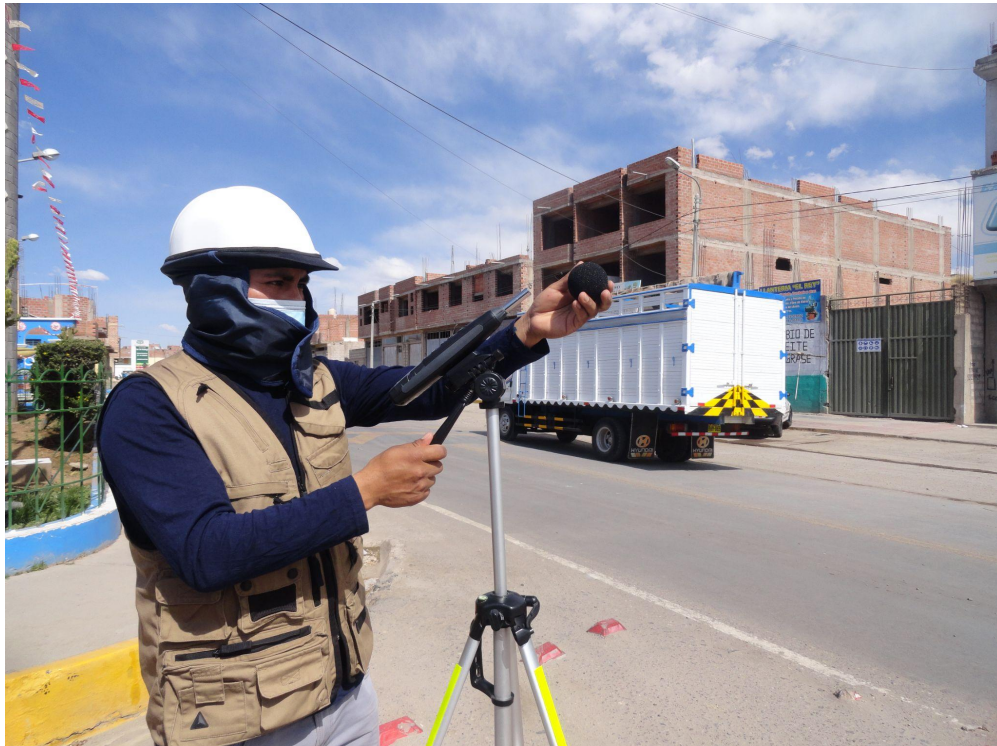
ANEXO 19. Posición y dirección del micrófono hacia la fuente móvil.
