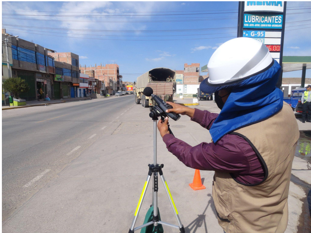
ANEXO 17. Sonómetro en ángulo de 45° sobre el plano inclinado paralelo al suelo.
