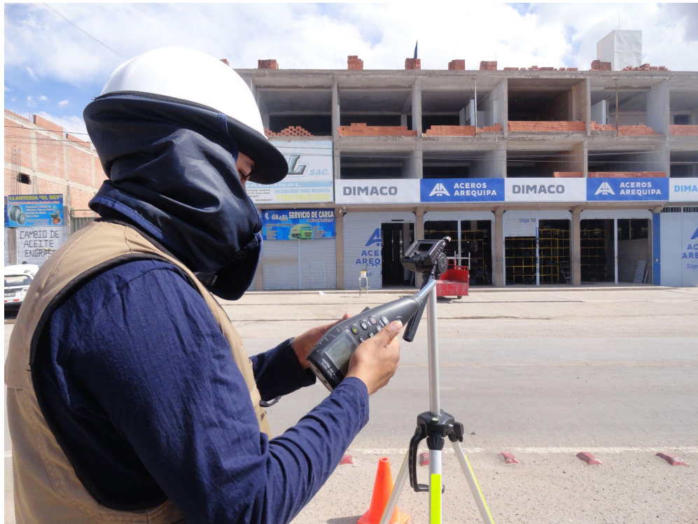
ANEXO 17. Sonómetro en ángulo de 45° sobre el plano inclinado paralelo al suelo.
