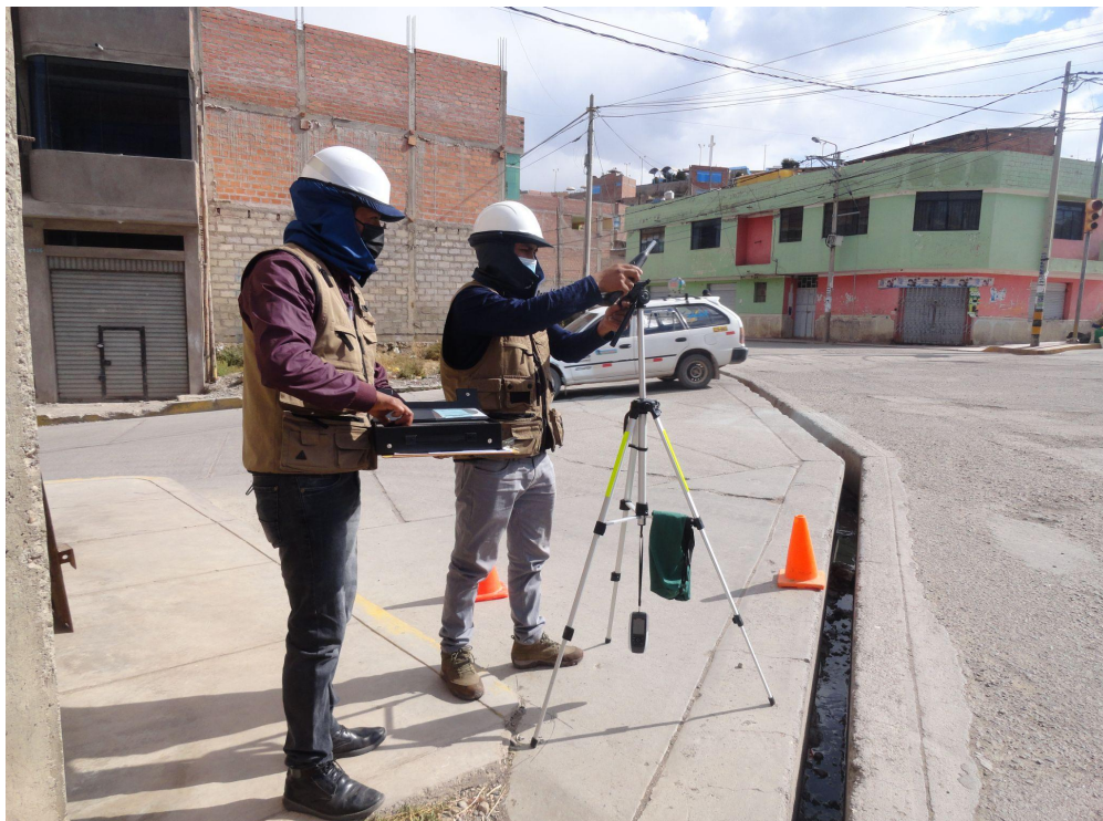
ANEXO 19. Posición y dirección del micrófono hacia la fuente móvil.
